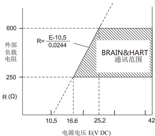
图2. 电源电压与外部负载关系图
