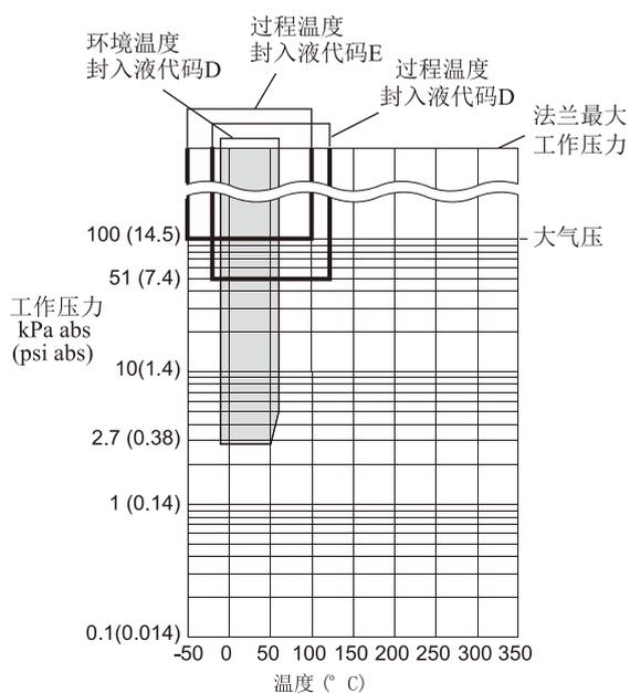
图1-2. 工作压力和过程温度
