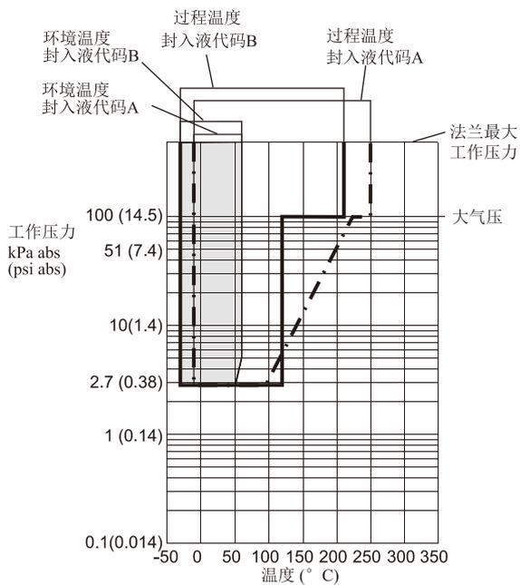
图1-1. 工作压力和过程温度
