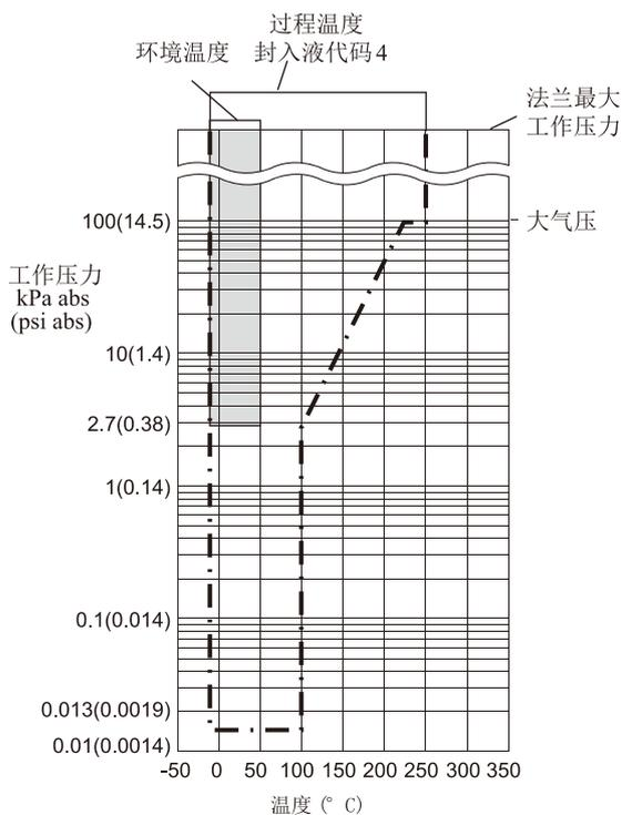
图1-4. 工作压力和过程温度
