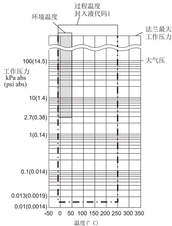
图1-3. 工作压力和过程温度
